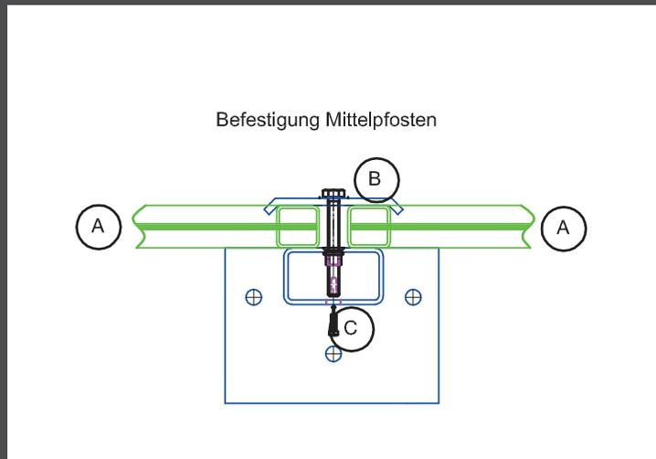
Zum Entfernen des Elements kann die Schraube nur bis zum Gewindeanschlag gelöst werden (z.B. für gelegentliche Wartungsarbeiten). Die Befestigungsmittel verleiben jedoch gemäß der Richtlinie 2006/42/EG mit der Schutzeinrichtung (Pfosten) verbunden.
